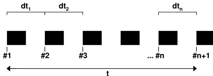
Mynd 1: Acceleration Mode. Myndin sýnir dökka bletti á tímaás. Dökku blettirnir tákna að geislinn í ljóshliðinu er rofinn. Minni  $\#n$  í klukkunni geymir tímasetninguna á n-ta rofi  $t_n$ . Mismunatíminn  $dt_n$  sem þarf fyrir hraðareikning fæst með  $dt_n = t_{n+1} - t_n$ .
